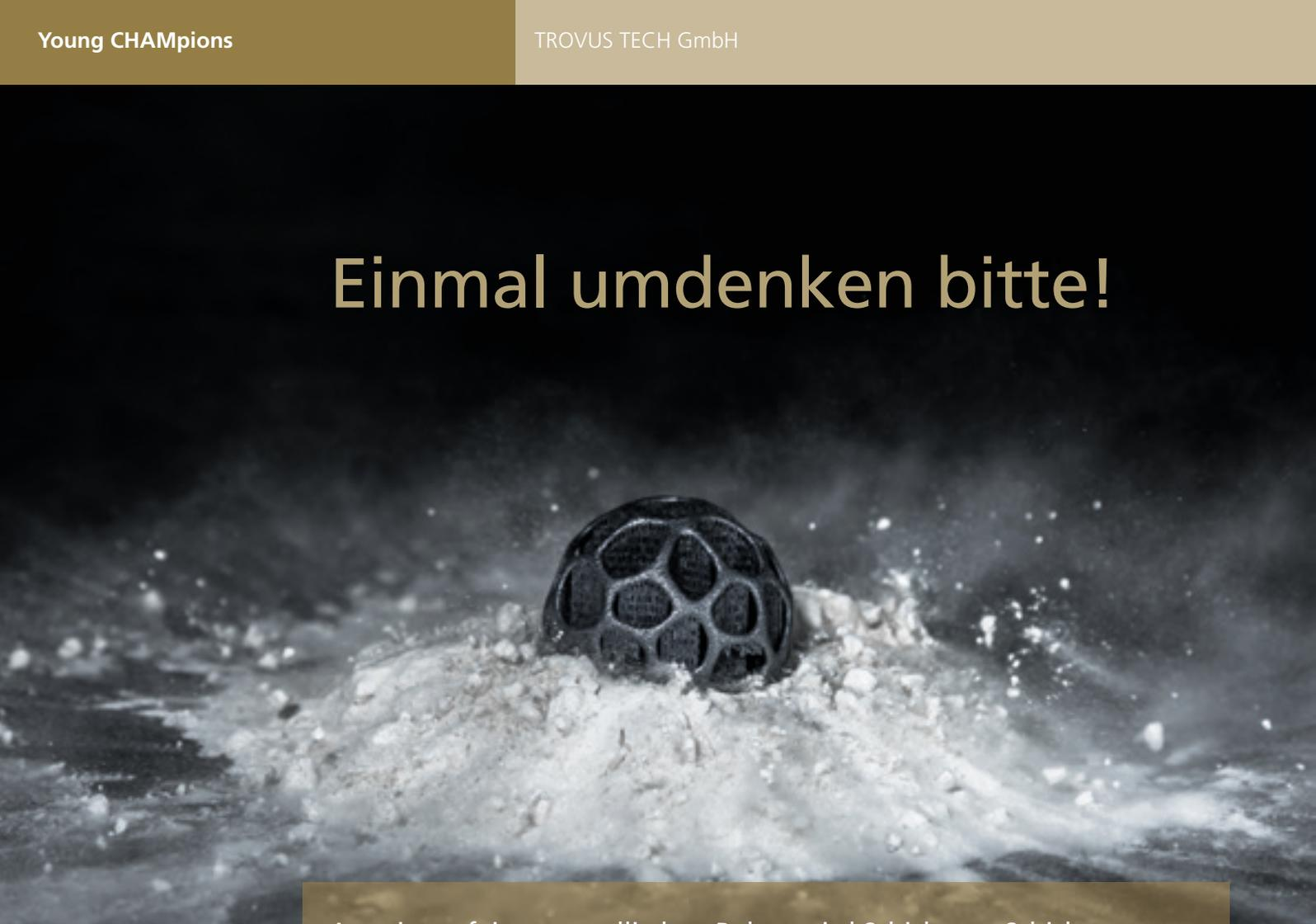
Aus einem feinen metallischen Pulver wird Schicht um Schicht aufgetragen. Die Schichten verschmelzen mittels Laser miteinander – und am Ende entsteht ein fertiges, komplexes Bauteil: Der 3D-Metalldruck revolutioniert die Branche und macht plötzlich Dinge möglich, von denen man lange nur träumen konnte.
